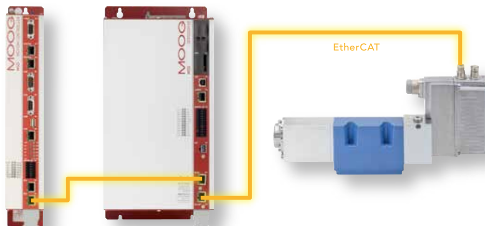
PLC、MSD モーションコントローラ、サーボドライブおよびサーボ弁の応用事例
